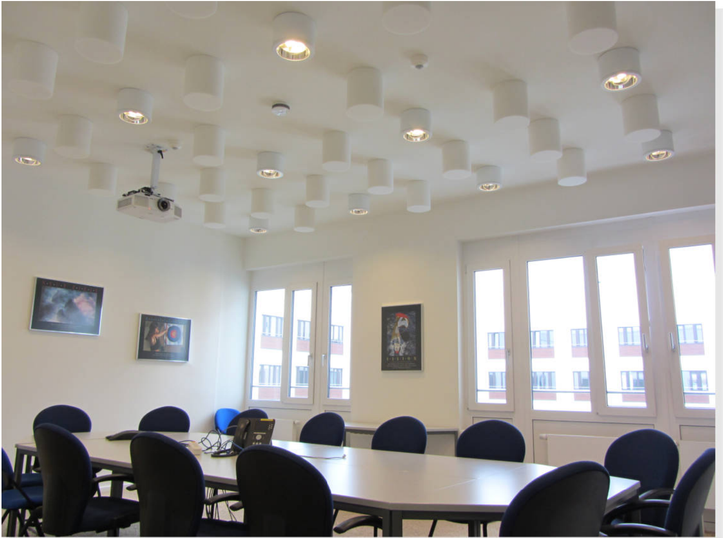
WILLBRANDT Absorber Zylinder mit Verklebung: Hier 250 mm, Durchmesser 230 mm, Standard Weiß oder Grau
